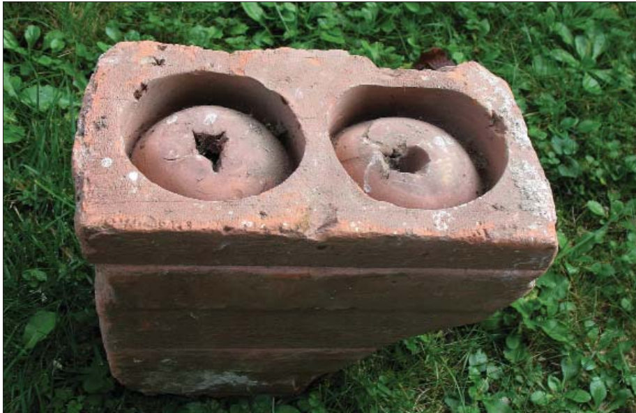
Abb. 1: Hohlziegel aus der Ziegelei Karl Kapeller, Lendorf bei Spittal a. d. Drau
