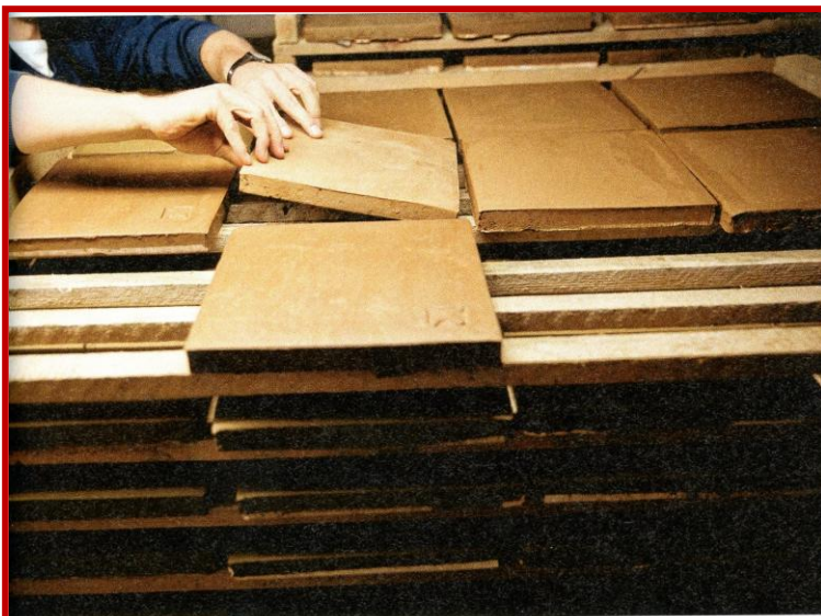
Einmal Visitenkarte bitte! Sarah Falkinger stempelt einen kleinen Falken, das Markenzeichen der Ziegelei, ins Eck. Und ab geht's mit dem Rohling in den Brennofen. Bild oben: Damit auf den letzten Metern nichts schiefeht, stapeln die letzten Ziegler ihre gebrannten Werke sorgsam übereinander.
