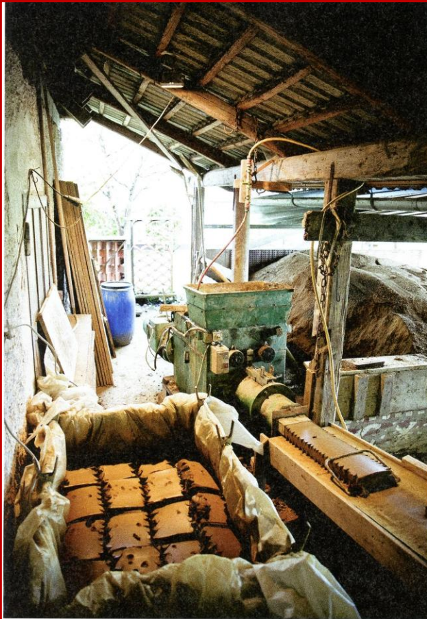
Links: Draußen vor dem ehemaligen Schweinestall läuft die Strangpresse. Sie verdichtet den bröseligen Lehm zu einer festen Masse, aus der die Rohlinge geschnitten werden. Im Bild: Fest werden die Rohlinge in Holzmodeln gedrückt. Ganz wichtig: Zeitungspapier - damit nichts pickt.
